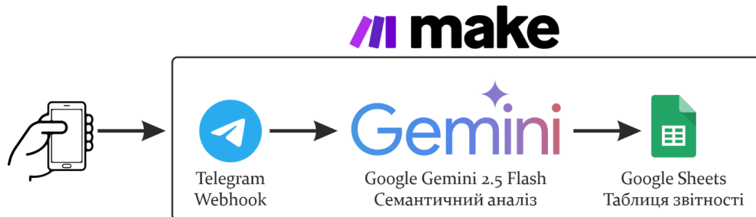
Рис. 1. Загальна архітектура персональної автоматизованої системи обліку професійної активності викладача (Джерело: ілюстрацію створено авторами самостійно)
